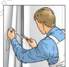
5. Découper le lé dans les coins et sur les bords et tapisser le lé suivant, bord à bord à joints vifs.
